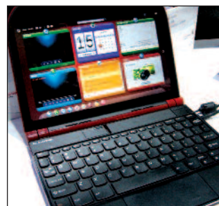
> GOOGLE ANDROID Un netbook construit par Lenovo sur la base du processeur Snapdragon à 1 GHz doté d'Android. Le tout pour moins de 200 euros.
